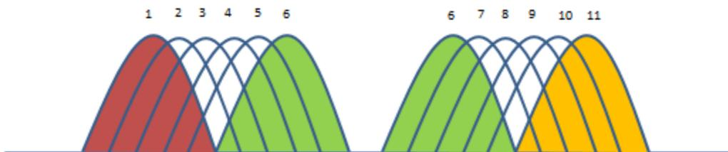
Como puede observarse en la imagen, el canal 1 se superpone con los canales 2, 3, 4 y 5, y por tanto los dispositivos que emitan en ese rango de frecuencias pueden generar interferencias. Lo mismo ocurre con el canal 6 y los canales 7, 8, 9 y 10. Es ideal que el canal que se elija para cambiar no se superponga con los cercanos, pero la realidad es que en los edificios es muy difícil que se cumpla
