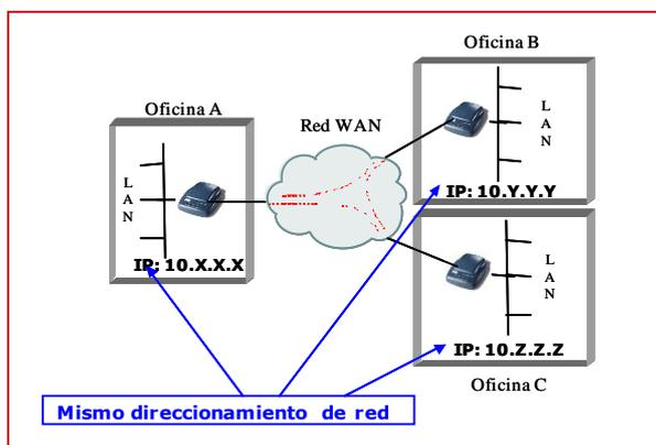
La conectividad necesaria en cada sitio se brinda instalando una acometida con multipar de cobre ó fibra óptica, dependiendo de las velocidades y necesidades del cliente, desde el nodo más cercano hasta el sitio del cliente. Dicha acometida se conecta a un CPE (Customer Premises Equipment) que cuenta con 1 (uno) interface RJ-45 hembra y un cable de red UTP Ethernet de 1 (uno) metro de longitud, como punto de acceso a la red LAN del cliente y delimitación del servicio.
